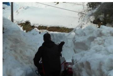
歩行式の除雪機の為、除雪範囲が400～500m程度に限られる事。軽トラを利用することで、遠方の除雪も可能となりましたが、歩行式の中型除雪機のため、積雪量が多いと非常に時間がかかり、体力も消耗します。さらに操作方法が難しく、慣れるまでなかなかうまく除雪できないし、時間もかかります。
